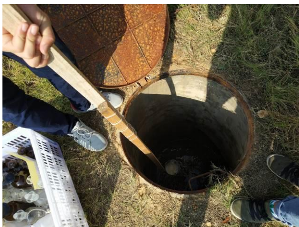
图 6.1-1 废水排放口采样
